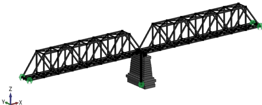
Рисунок 5.2 – КЭ модель фрагмента моста для расчета массивного фундамента
